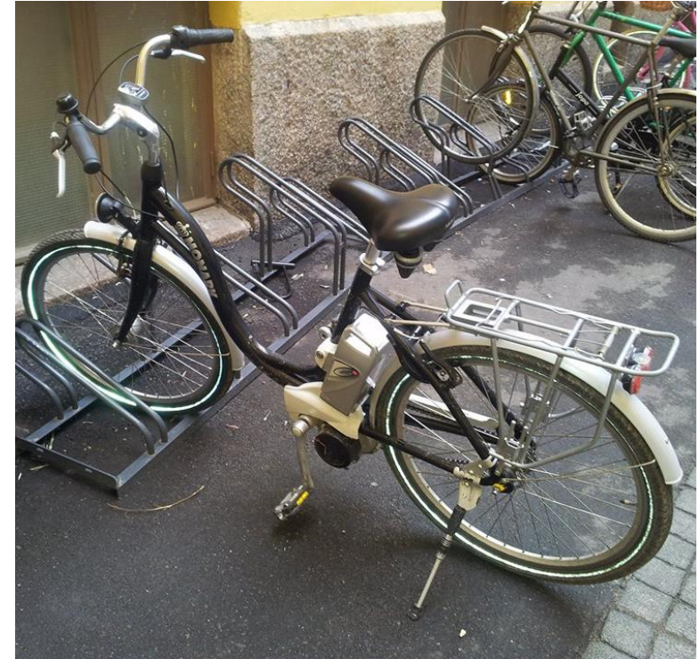
Kuva: teollisuusakkuksi luokiteltavaa litiumioniakkua hyödyntävä sähköpolkupyörä
